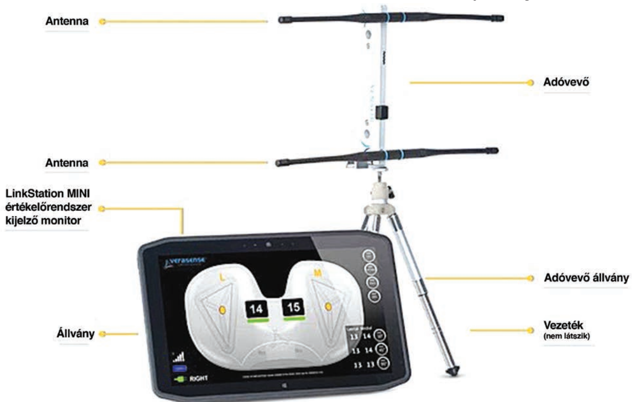
6. ábra | Verasense™ szenzor rendszerhez tartozó jelérzékelő és kijelző monitor
