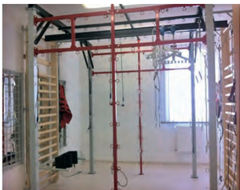
1. ábra | A vertikális függesztő szerkezet
